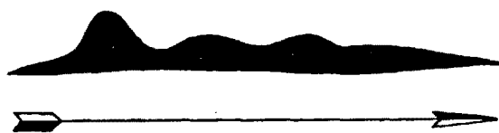
Fig. 2. Diagramme après 24 min d'ultra-centrifugation d'une solution de protéine Y de Lapin dans un tampon phosphatique \mu 0,10, pH 7,6. Concentration en protéines: 1,5\ \text{g}/100\ \text{cm}^3 de solution. Vitesse: 59780 t/min.
